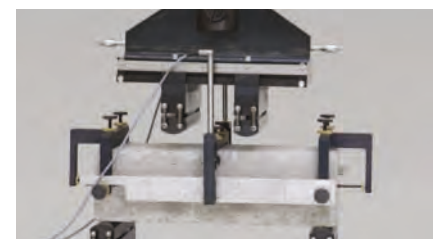
Bild 3: Verformungsaufnehmer für die Messung der Durchbiegung
