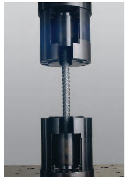
Bild 4: Probenhalter und Probenverguss für Betonrippenstahl
