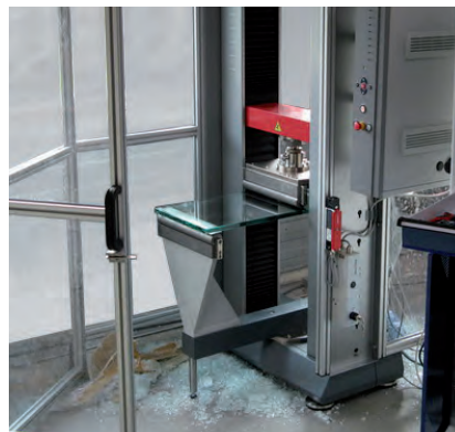
Bild 1: 4-Punkt-Biegeprüfung an Bauglas
