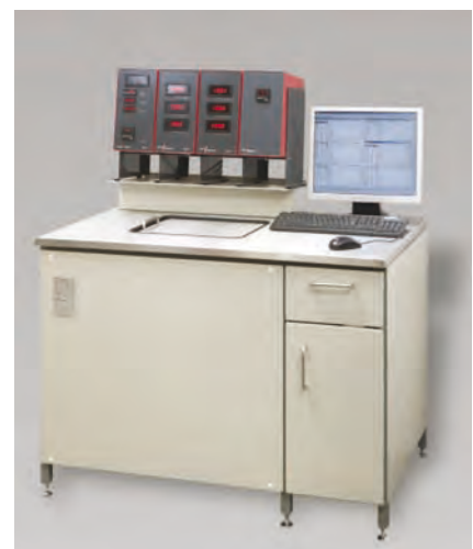
Bild 3: Differentialkalorimeter ToniCAL eingebaut in Temperiereinrichtung
