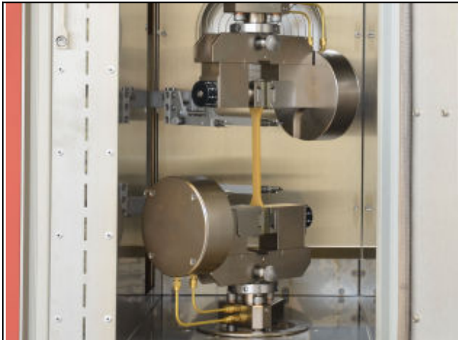
Pneumatik-Probenhalter Typ 8297 für Temperierkammer, Fmax 2,5 kN, einseitig schließend
