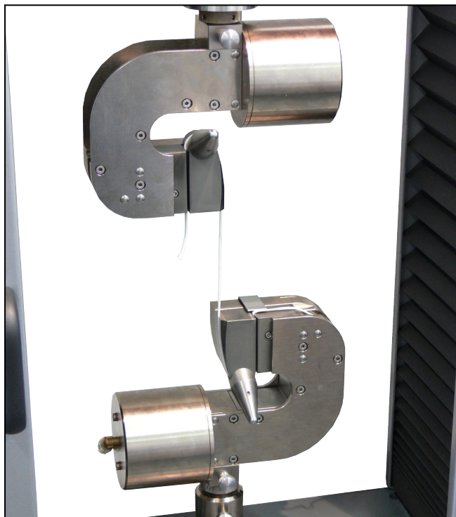
Umlenk-Probenhalter für hochfeste Kunststoffgarne Typ 8297, Fmax 2,5 kN
