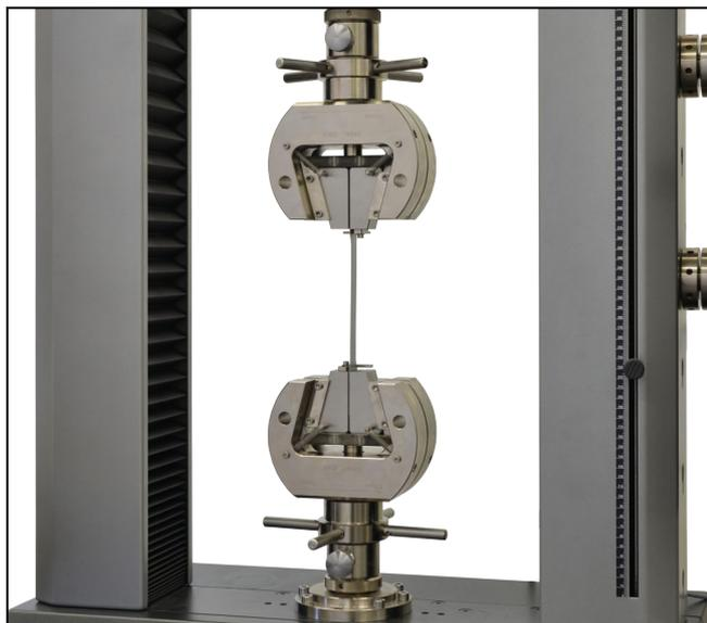
Keil-Probenhalter Typ 8404, Fmax 50 kN
