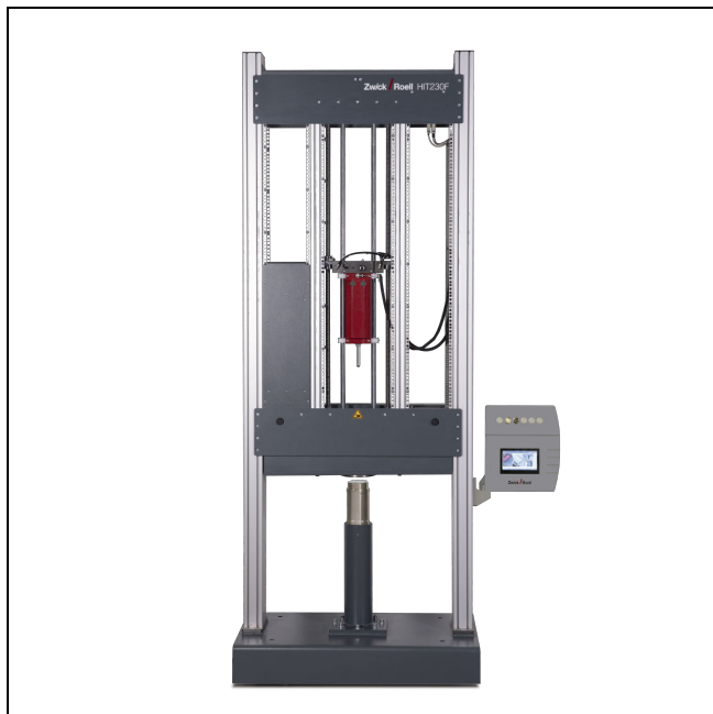
Amsler HIT230F, Multiaxiale Durchstoßprüfung
