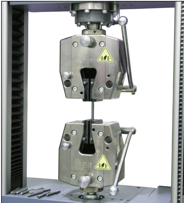
Wedge grips type 8402, Fmax 50 kN
